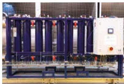
*blubalance* est une solution de traitement des eaux de refroidissement sans produit chimique, qui permet de lutter contre le tartre, la corrosion et la biocontamination. La solution permet de diminuer la micropollution liée aux produits chimiques et de réaliser en moyenne 30% d'économies d'eau.
