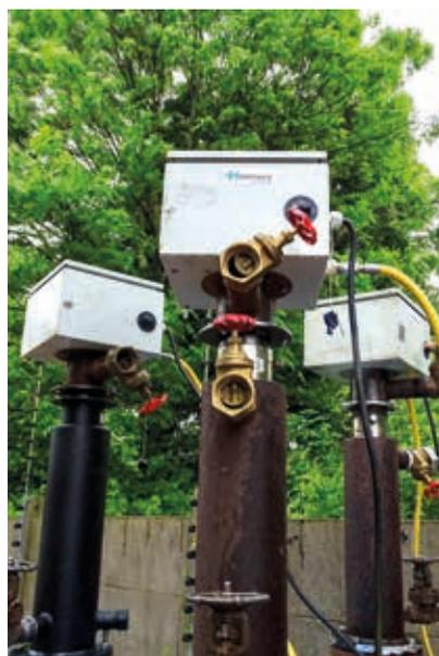
Haemers Technologies, spécialisé dans le traitement thermique des sols pollués, étend la portée de ses méthodes de traitement thermique au traitement des eaux souterraines polluées. L'amélioration consiste à combiner la technologie de traitement thermique - désorption thermique *in situ* ou *ex situ* (ESTD / ISTD) - avec une des techniques de traitement chimique - oxydation chimique *in situ* ou *ex situ* (ISCO / ESCO).
