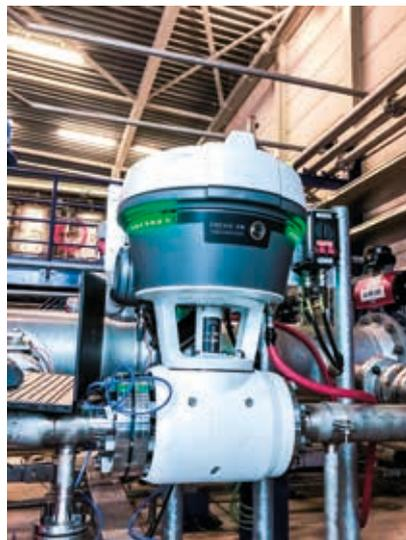
Conçue dans le cadre de la joint-venture Focus-One réunissant Samson et Krohne, Krohne dévoile la nouvelle vanne de régulation réunissant dans un seul appareil des vannes et des technologies de mesure associées à des fonctions de diagnostic et de contrôle.
